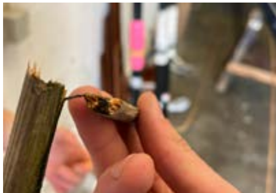
Oben: der Einkauf aus dem Baumarkt, unten: Die morsche Halbrundleiste des FEGers
